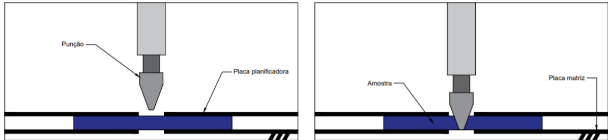
Figura 38: Perfuração até o fundo da amostra
