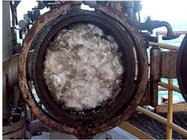
Figura 31: Formação de hidratos no interior de um duto [21]
