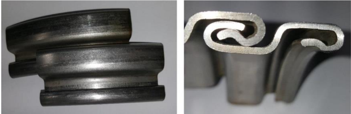
Figura 17: Perfil intertravado da carcaça [3]
