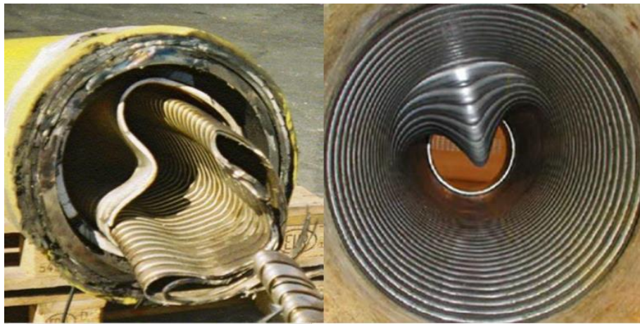
Figura 20: Falha por colapso da carcaça intertravada [3]
