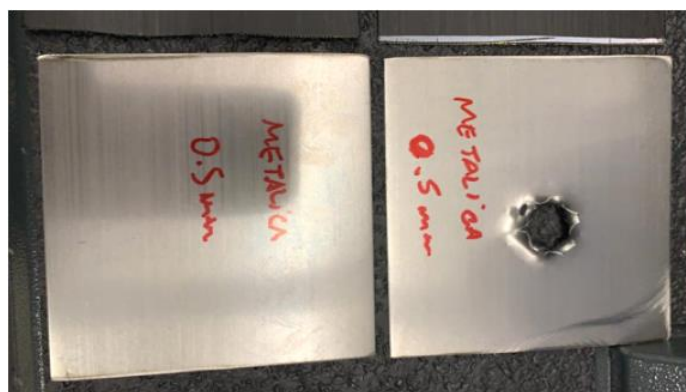
Figura 124: Fita metálica antes e após a perfuração
