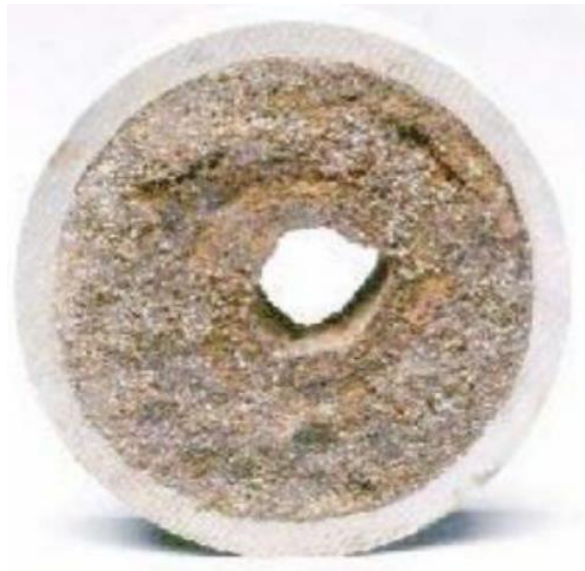
Figura 32: Formação de Parafinas no Interior de um duto rígido [21]
