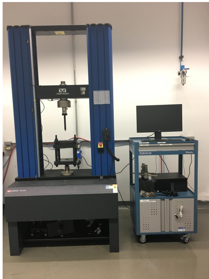
Figura 41: Máquina de ensaio mecânico EMIC 23-100 com o dispositivo de perfuração posicionado
