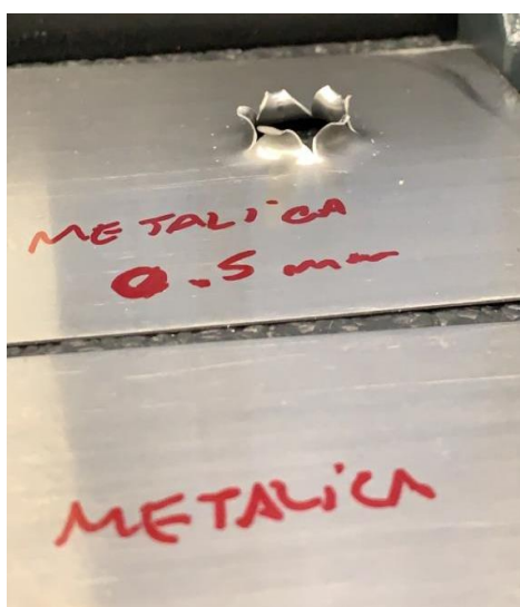
Figura 126: Rebarba gerada pela fratura frágil
