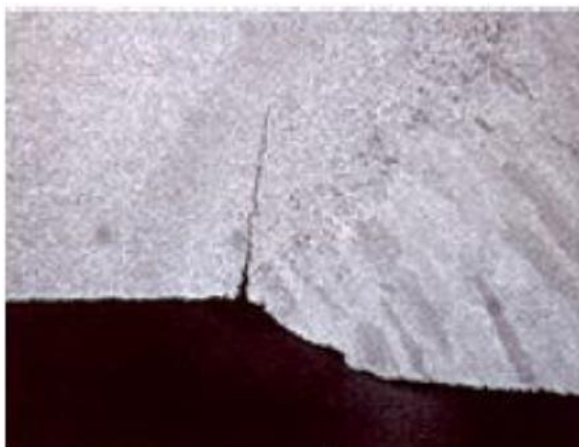
Figura 37: Trinca gerada pela corrosão sob tensão [24]
