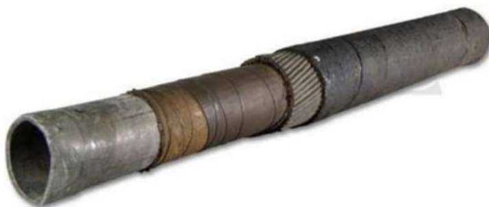
Figura 5: Duto HAIS utilizado na segunda guerra mundial [12]
