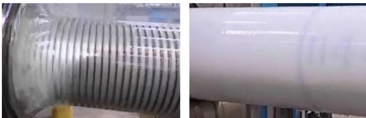
Figura 21: Extrusão da barreira de pressão [3]
